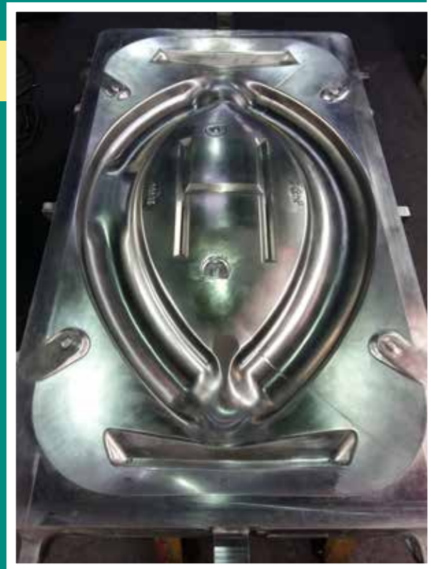
SPF Ferrynox 37 - 6 000 kg Dimensions : 2 500 x 1 500 x 230 mm
