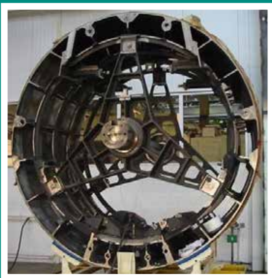
Invar Ferrynox N36 - 13 000 kg Diameter : 3 500 mm
