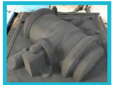
Les prototypes peuvent donc être reproduits plusieurs fois après chaque modification sans frais de modèle, sachant que la matière est recyclée pour réduire le coût de prototypage.
